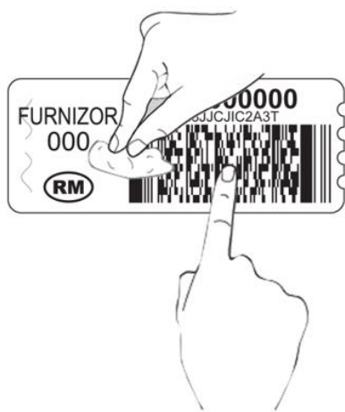
a) aplicarea sigiliului de protecție pe suport
