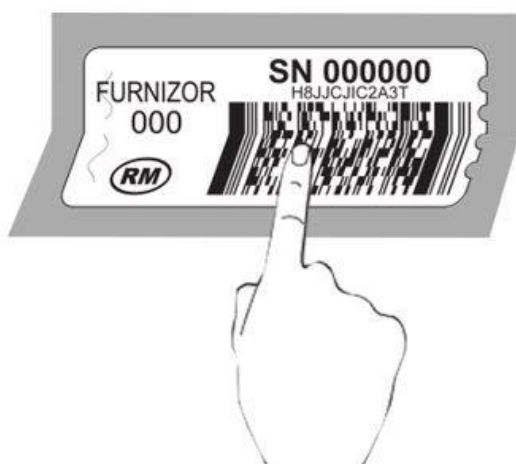
a) aplicarea primei jumătăți a sigiliului de protecție pe suport
