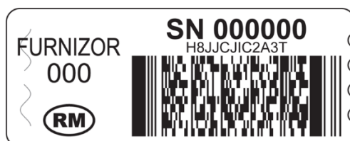
Figura 13. Elementele de siguranță a sigiliilor de protecție aplicate pe carcasa MCC/IF
